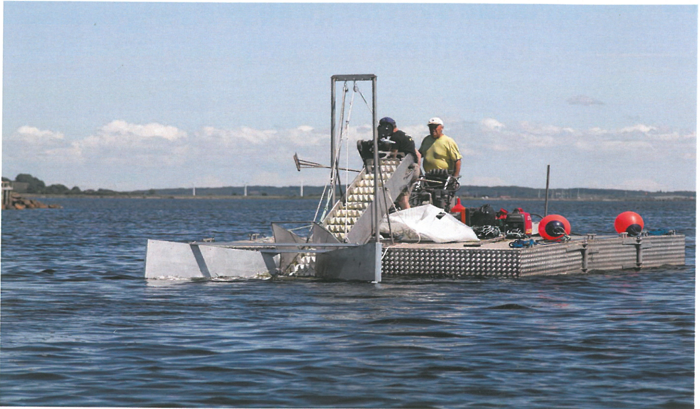
Fig. 1. Sejlene "mejetærsker" til høst af ålegræsfrø. Maskinen er under udvikling og blev testet i Limfjorden 2014. De høstede frø skal sås få cm nede i havbunden, hvorved de får bedre rødder, end hvis de sås ud på havbunden. (Foto: Flemming Gertz)
